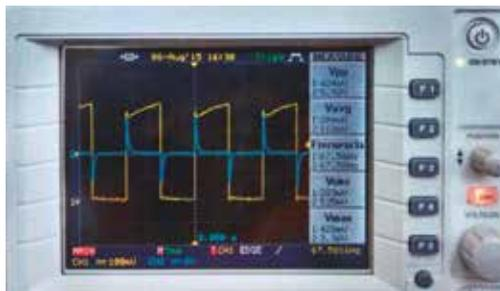
**Figura 2.** Resultado del circuito implementado visualizado a través del osciloscopio para el filtro paso alto diseñado y simulado.
